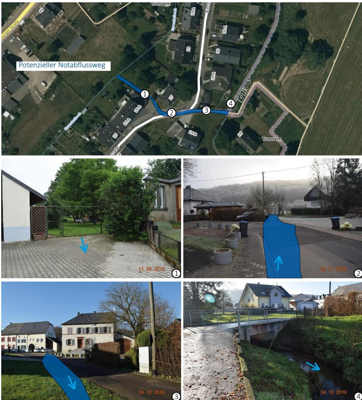
Im Zuge des geplanten Straßenausbaus der Kirchstraße soll die Wasserführung im Straßenraum mit besonderer Berücksichtigung von Starkregenabfluss sowie Hochwasser des Sprekelbaches betrachtet und der Notabflussweg des Wassers hergestellt bzw., wie in diesem Fall, verbessert werden, um ein Ausbreiten und Abfließen entlang der Straße zu vermeiden und die
