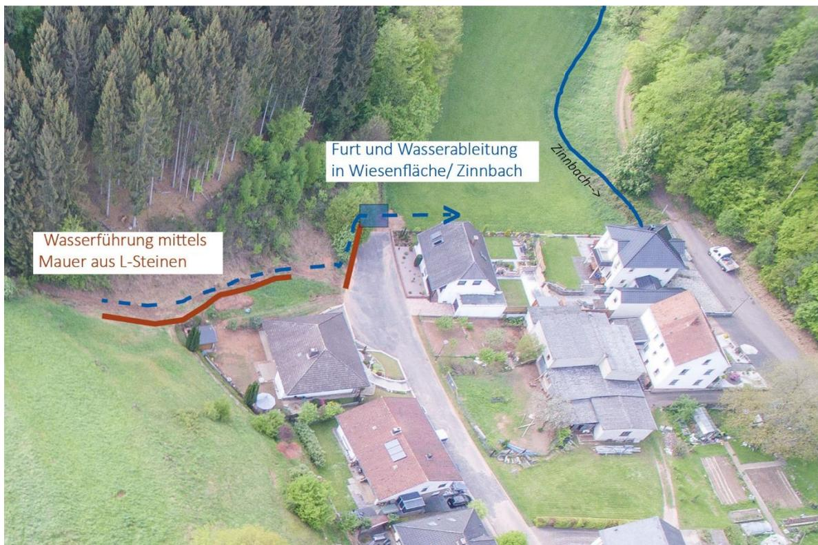
Ergänzend dazu wird ebenfalls im Bereich der Straße Unterm Halstenberg (entlang der Wendefläche) eine Wasserführung mittels Winkelstützwänden errichtet. Auf einer Länge von 20 Metern soll diese das vom oberen Teilbereich kommende Wasser entlang der Straße auf eine im Wirtschaftsweg geplante Furt mit Wasserführung leiten. Von dort aus kann das Wasser über eine flache, in der angrenzenden Wiese angelegte, Mulde in Richtung des Zinnbaches abfließen. Die Winkelstützwand
