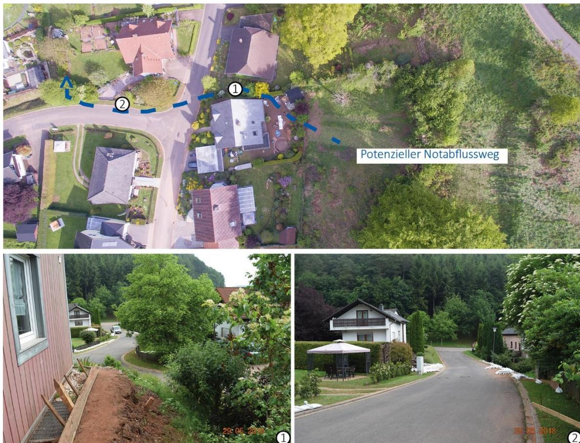
Unbedingt bei einem solchem Vorhaben mitberücksichtigt und geplant werden muss der weitere Abflussweg auf der Straße in Richtung Zinnbach, sodass eine Verschärfung der Situation für Unterlieger sowie das Anwesen im Kurvenbereich (Haus Nr. 16) vermieden wird. Von den betroffenen Anliegern wird die Prüfung einer Befreiung der betroffenen Grundstücke aus dem geltenden Bebauungsplan gefordert, um private Einzelmaßnahmen baulicher Art umsetzen zu können.
