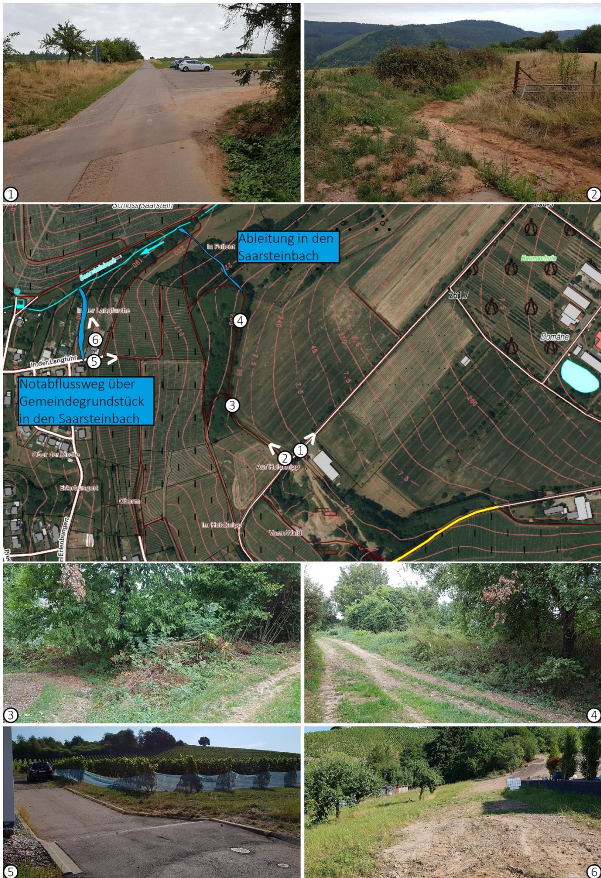
Abb. 8: Außengebiet oberhalb NBG Erlenbungetert und Notabflussweg in den Saarsteinbach
