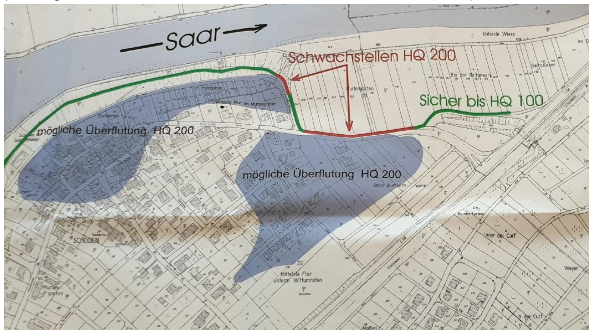
Abb. 9: Schutzziel des Deiches und Schwachstellen bei HQ200
