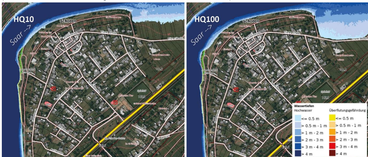
Abb. 2: Hochwassergefahrenkarte Saar– Bereich Schoden, HQ10 und HQ100 (Quelle: Landesamt für Vermessung und Geobasisinformation Rheinland-Pfalz)
