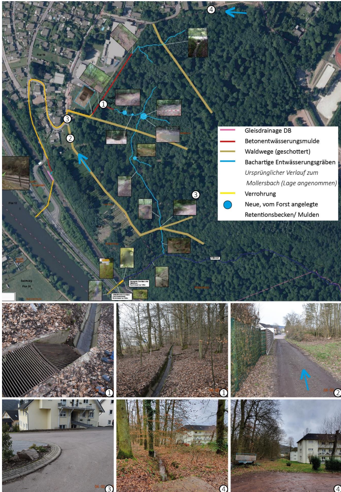
Abb. 35: Entwässerung im Wald zwischen „Waldesruh“, Tectro-Gelände und Königstraße
