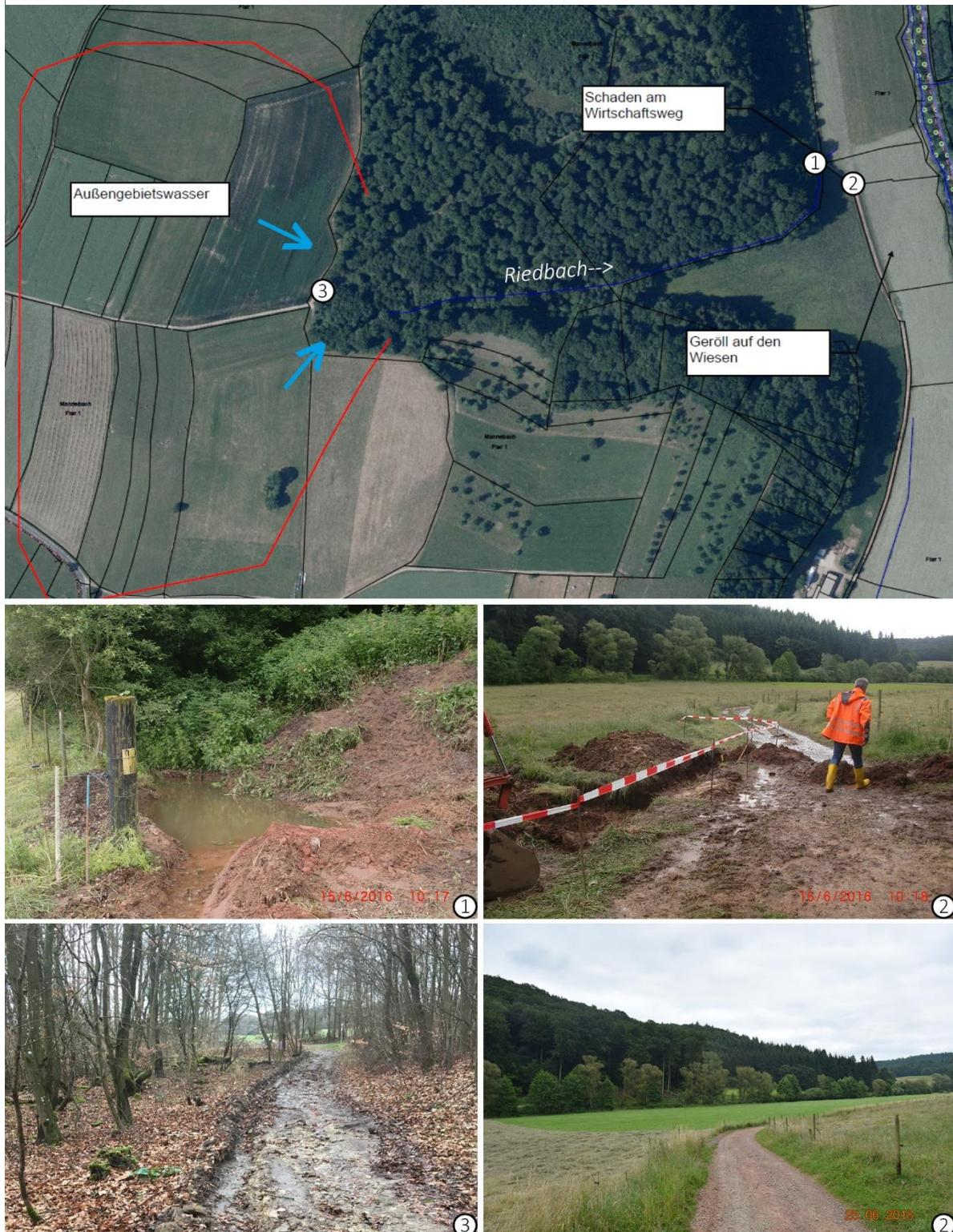
Um die Überschwemmung des Weges zu vermeiden, sollte die Verrohrung entfernt und im Weg durch eine Furt ersetzt werden. Im Anschluss soll der Bachlauf als etwa zehn Meter breiter Gewässerbereich (offenes Gerinne) in den Wiesen angelegt und bis in den Mannebach geführt
