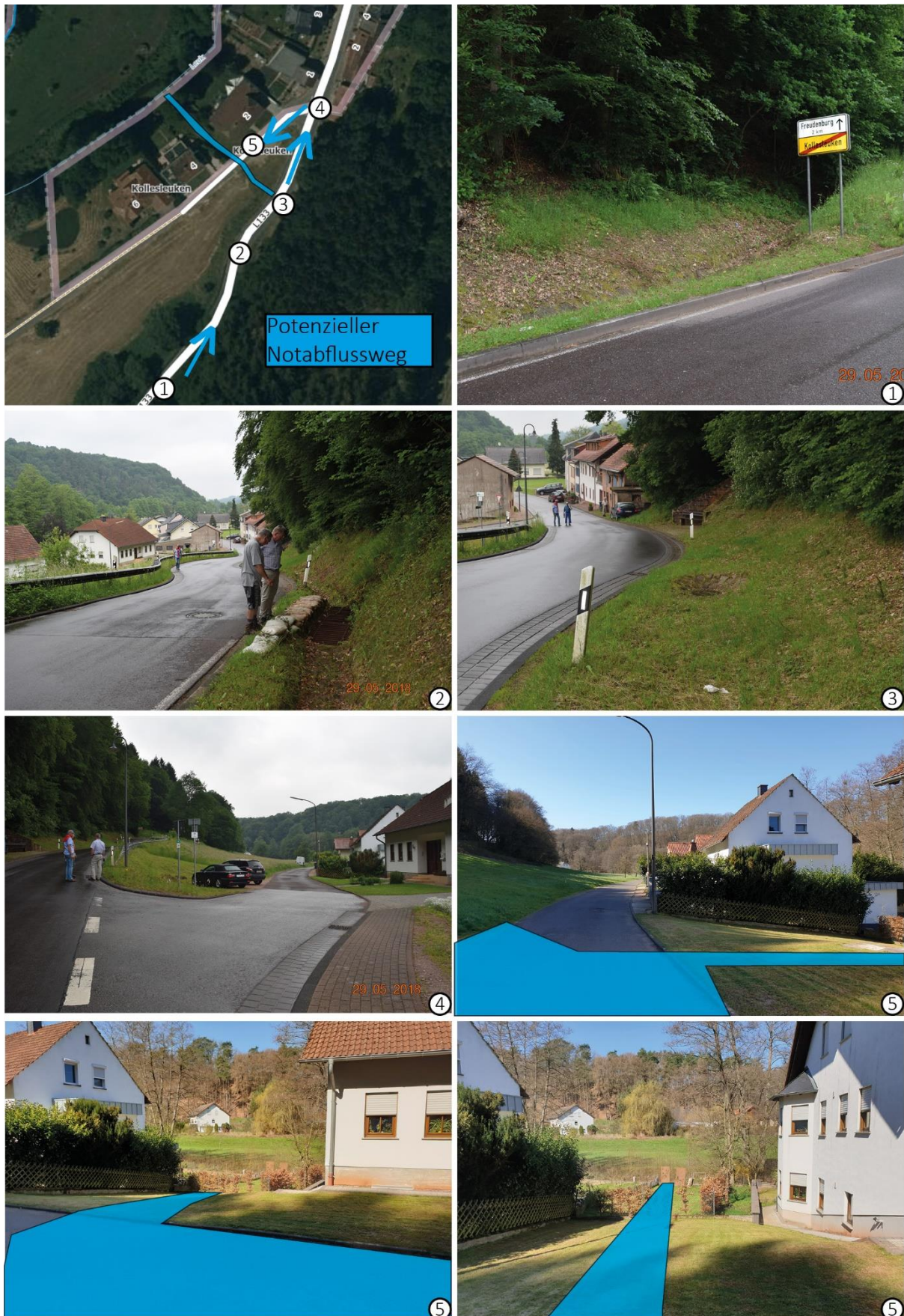
Abb. 11: Situation an der L 133 und potenzieller Notabflussweg in die Leuk
