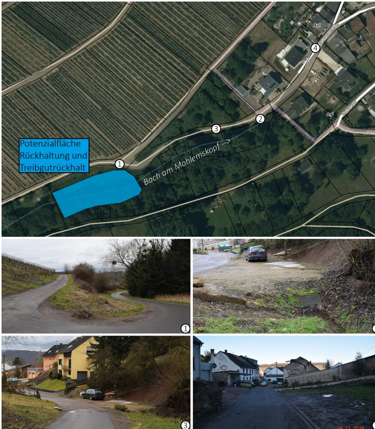
Abb. 10: Potenzialfläche zur Schaffung von Retentionsraum und Treibgutrückhalt am Bach am Mohlemskopf oberhalb der Brunnenstraße
