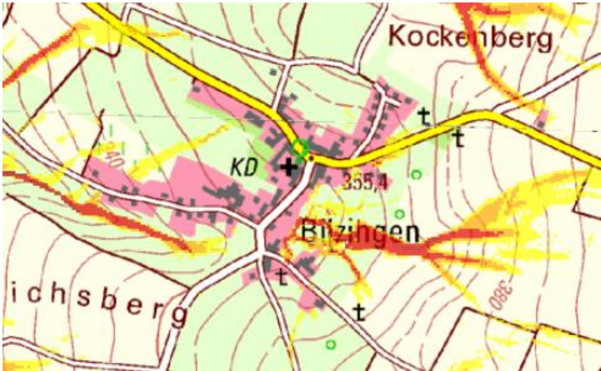
Abbildung 2: Sturzflutenstehungsgebiet Bergland, Abflusskonzentration (Quelle: Ministerium für Klimaschutz, Umwelt, Energie und Mobilität (MKUEM), Starkregenkarte Zugriff: 28.06.2022)
