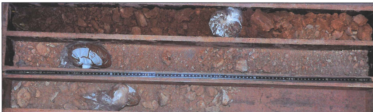
Foto 4: Erkundungsstelle 2 – Bohrgut Kleinrammbohrung
